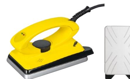
Dieses ergonomische Waxgerät ermöglicht das Waxen in alle Richtungen. Stufenlose Temperaturregelung von 100 °C bis 160 °C. Die dicke Druckgussplatte aus Aluminium für eine optimale Wärmespeicherung ist mit einer Rautenstruktur versehen, welche die Waxverteilung und -komprimierung optimiert.
