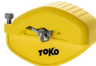
Seitenwangenhobel für problemloses Abziehen der ABS-Seitenwange. Nach dem Entfernen der Seitenwange lässt sich die Stahlkante leichter und präziser nachfeilen. Der Sidewall Planer wird mit dem viereckigen Messer (Radius 3) ausgeliefert.
