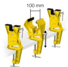
Weltcup-erprobte Einspannvorrichtung zur Fixierung von Alpinski. Die beiden äusseren Auflagen sind höhenverstellbar und lassen sich zur Kantenpräparation neben der normalen 90° Position auf 60° abwinkeln. Die robuste mittlere Klemmvorrichtung mit breiter 70 mm Klemmfläche öffnet bis 100 mm. Breitere Skis lassen sich durch Klemmen der Bindung sicher fixieren. Inkl. 2 Skistopperhalter.
