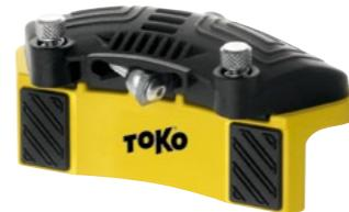
Professioneller Seitenwangenhobel für problemloses Abziehen der ABS-Seitenwange. Nach dem Entfernen der Seitenwange lässt sich die Stahlkante leichter und präziser nachfeilen. Mit beschichteten Führungsplatten und stufenlos verstellbarem Hartmetallmesser. Der Sidewall Planer Pro wird mit dem viereckigen Messer (Radius 3) ausgeliefert.
