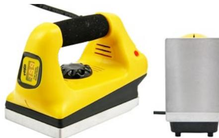
Eine 15 mm dicke Bodenplatte garantiert eine konstante Temperatur. Die Temperatur des Waxeisens wird per Mikroprozessor geregelt und überwacht. Heizbereich von 90 – 180 Grad. Im hinteren Bereich ist die Heizplatte des T18 angewinkelt, um die Applikation von JetStream 2.0 zu vereinfachen. Die Frontplatte ist plan um die Gleitwaxe gleichmäßig zu applizieren. Dieses Waxeisen ist insbesondere geeignet für die Verarbeitung von temperaturempfindlichen Spezial- und Rennwaxen. Inkl. Iron Cover.
